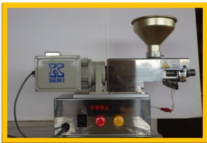
▲搾油機：菜種油と油粕が同時に出ます
